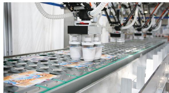
Деталь захватывающих головок роботизированной мультиустановки для загрузки стаканчиков йогурта
